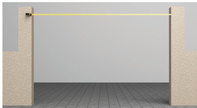
5 Mesurer en haut. Retenir la plus petite mesure;
