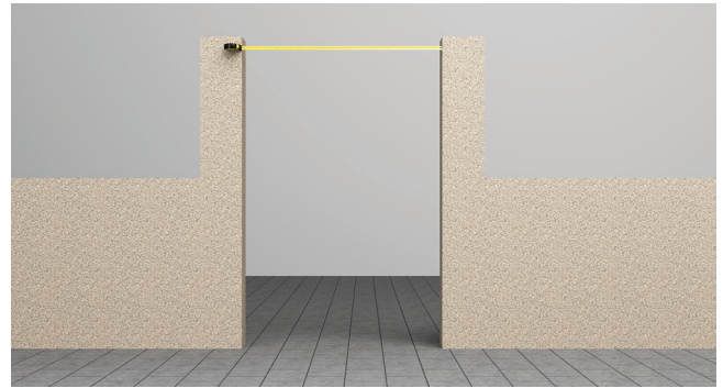
3 Mesurer en haut. Retenir la plus petite mesure;
